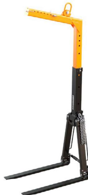
Die hydraulische Teleskop-Krangabel KM 401 HT mit ihrem hydraulischen Schwerpunktausgleich besitzt neben den Merkmalen der regulären KM 401 H Krangabel zusätzlich die Möglichkeit auf eine Nutzhöhe von bis zu 2500 mm auszufahren.
