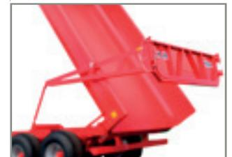
Der BIGAB Kipp-Hänger ist dank seines einfach verstellbaren Fahrwerks zur Einstellung der Stützlast auf dem Markt einzigartig. Er ist für Radbagger und Traktoren geeignet. Das Chassis ist aus hochfestem Stahl und der Kippbrückenkörper aus verschleißfestem Stahl gefertigt, was den BIGAB Kipp-Hänger zu einem sowohl leichten als auch robusten Anhänger macht.
