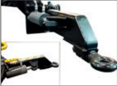
Der BIGAB kann mit einer Deichsellenkung ausgestattet werden. Sehr praktisch bei dem Wenden in engem Raum. Die Deichsellenkung erleichtert zudem das Heranfahren an eine Kippbrücke im Rückwärtsgang.
