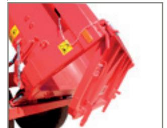
Mechanisch hebbare Heckklappe (nur für BT-8)
