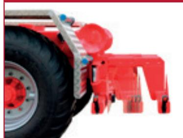
Für die Straßensicherheit bieten wir einen mechanisch und hydraulisch verstellbaren sowie festen hinteren Unterfahrschutz.
