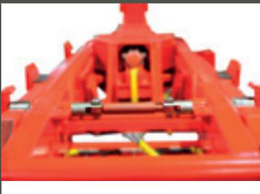
BIGAB bietet mechanische Containersicherungen als Standardausstattung, kann jedoch auch hydraulische Sicherungen bereitstellen, um die Kippbrücke an dem Rahmen zu verriegeln. Eine hydraulische Containersicherung wird im Foto gezeigt.
