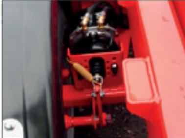
BIGAB bietet verschiedene Bremsstypen, die für unterschiedliche Zugfahrzeuge geeignet sind. Wir können hydraulische Bremsen, Druckluftbremsen (positives/Tristop-System) und eine Kombination daraus bereitstellen.
