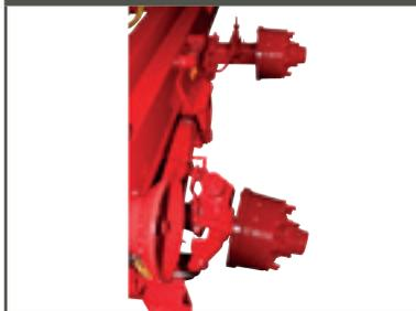
Nachlauf- oder Zwangslenkachse können an gefederten BIGAB Einheiten angebracht werden. Dadurch wird sowohl die Abnutzung der Reifen vermindert als auch der Boden geschont. Außerdem wird die nötige Zugkraft geringer.
