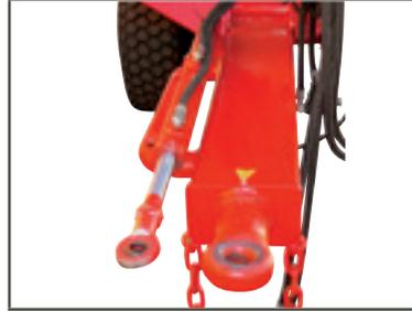
Der BIGAB kann auch mit Zwangslenkachsen mit Hydraulikzylindern ausgestattet werden, welche die Bewegungen des Traktors automatisch erkennen. Besonders dann von Vorteil, wenn eine genaue Steuerung des Anhängers notwendig ist. Für diese Ausstattung ist eine entsprechend angepasste Zugmaschine notwendig.
