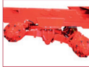
BIGAB Anhänger können mit einem gefederten Fahrwerk ausgestattet werden, um den Komfort beim Fahren auf unebenen Oberflächen, insbesondere bei hohen Geschwindigkeiten, zu erhöhen, was sowohl Vorteile für den Fahrer als auch für die Maschine hat. Es ist außerdem eine lange Federung mit größeren Raddurchmessern erhältlich.
