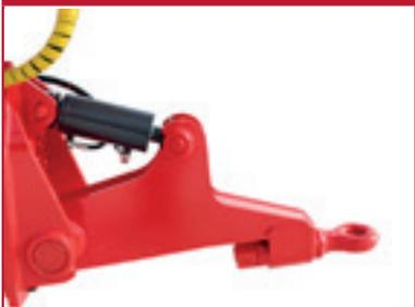
Unser Angebot umfasst auch eine gefederte Zugdeichsel, die Ihnen beim Fahren einen höheren Komfort bietet. Hierbei erhöht sich der Fahrkomfort durch das Dämpfen von Stößen von dem Anhänger. Bei BIGAB 22–27 ist dies als Standardausstattung eingeschlossen, eine gefederte Zugdeichsel ist optional für die meisten Modelle erhältlich.
