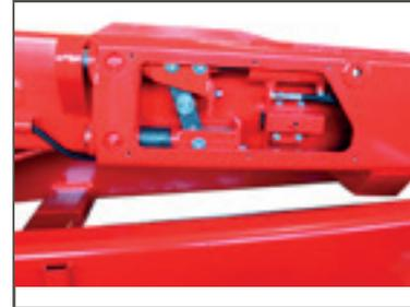
Wir bieten eine hydraulische Steuerung für Kipp-, Auf- und Absetzvorgänge auch für die Modelle an, die nicht standardmäßig damit ausgestattet sind. Dies stellt eine Alternative für Benutzer dar, die Kipp-, Auf- und Absetzvorgänge vom Fahrerhaus aus steuern möchten.
