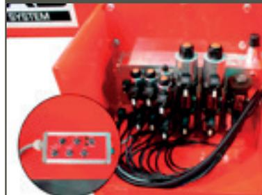
Um die Anzahl an Schläuchen an dem Zugfahrzeug zu verringern, bietet BIGAB eine Reihe von elektrischen Steuerventilen im Fahrerhaus, zusammen mit der Lastenerfassung.
