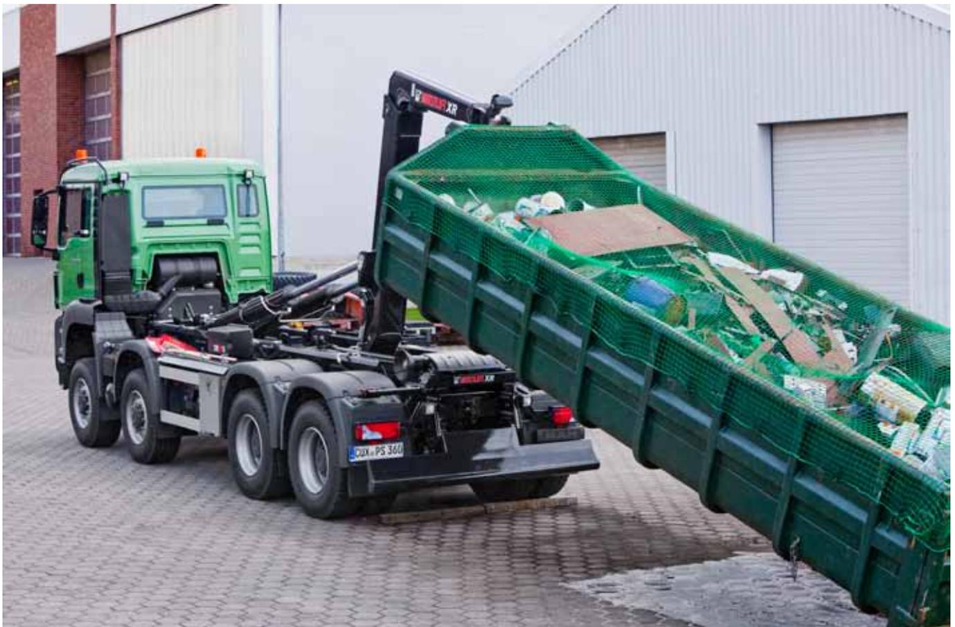
Die angegebenen Behälterlängen berücksichtigen die derzeit aktuelle DIN 30722. Bei den min. Behälterlängen kann der Behälter teilweise nur bedingt gekippt werden. Bei der max. Behälterlänge ist die Überhangsregelung 400 mm zum Unterfahrerschutz einzuhalten.
