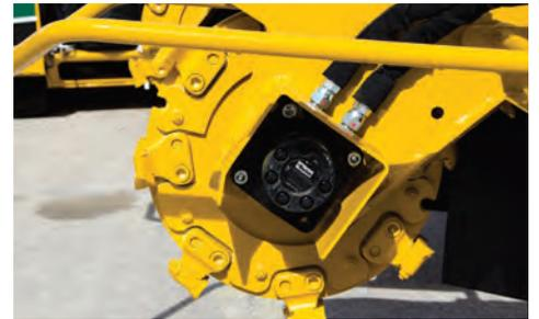
**PATENTIERTES YELLOW JACKET™ FRÄSZAHNSYSTEM.** Das Yellow Jacket™ Fräszahnsystem garantiert einen schnellen, einfachen Service und eine lange Lebenszeit der Zähne und Halter.
