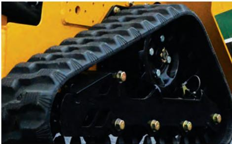
**LÄNGSTE RAUPENKETTEN DER KLASSE.** Die längsten Raupen Ihrer Klasse bieten gleichmäßige Stabilität und ein leichtes Laden und Abladen der Maschine, sowie den geringsten Bodendruck der Klasse, womit eine Rasenbeschädigung vermieden wird.
