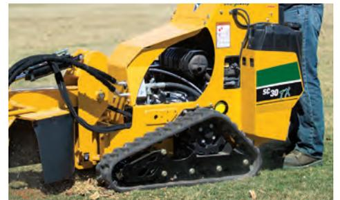
**HYDRAULISCH ANGETRIEBENES FRÄSRAD UND HYDROSTATISCHER FAHRANTRIEB.** Der hydrostatische Fahrtrieb sowie das hydraulisch angetriebene Fräsrad schließen die Wartung und Kosten für Riemen und Riemenscheiben aus.
