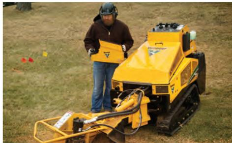
**AUSSCHWENKBARER BEDIENSTAND.** Durch den ausschwenkbaren Bedienstand an der Seite der Maschine hat der Bediener zusätzlich die Möglichkeit den besten Sichtwinkel auf den Baumstumpf zu wählen. Alle Funktionen des Fräsrades und des Kriechgang-Fahrtriebes (vorwärts/rückwärts) können vom Bedienstand aus gesteuert werden.
