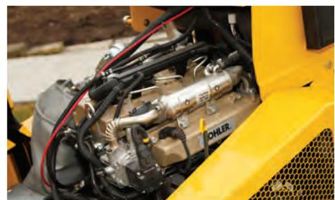
**KRAFTVOLL AM BAUMSTUMPF.** Die SC40TX ist mit einem leistungsstarken 29,8 kW (40 PS) Tier 4 Final (EU Stufe IV) Dieselmotor mit Nachverbrennungs-System ausgestattet.
