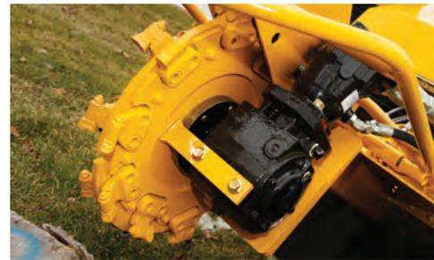
**POW-R™ PLATTEN.** Das Fräsrade ist mit der Vermeer eigenen Pow-R™ Platten Technologie ausgestattet, welche mehr Schwungmasse auf das Fräsrade bringt, die Lebensdauer der Zahnhalter erhöht und die Rezirkulation des Fräsmaterials reduziert.
