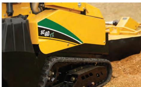
**FÜR JEDES GELÄNDE.** Durch das gegenläufige Raupenfahrwerk lässt sich die Maschine beim Fräsen von Baumstämmen schnell und einfach neu positionieren und bietet zudem eine erhöhte Standfestigkeit. Der Einsatz bei weniger idealen Bodenverhältnissen ist durch das Raupenlaufwerk garantiert.
