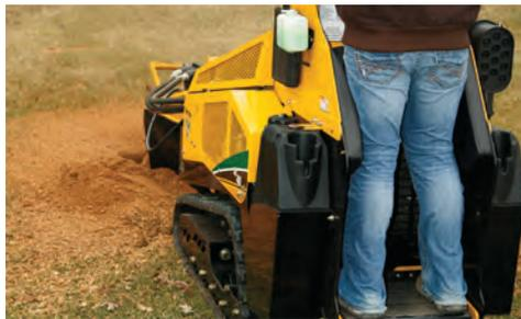
**ERSTE AUF DEM MARKT.** Die SC40TX ist die erste Maschine Ihrer Art, welche von einer Standplattform aus gesteuert werden kann. Sie glänzt durch Ihre hohe Fahrgeschwindigkeit von bis zu 90 m/min.
